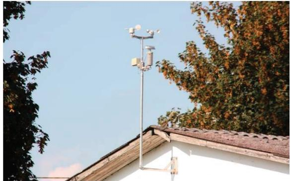
**Abbildung 8: Windmessstation mit Schaufelanemometer**
